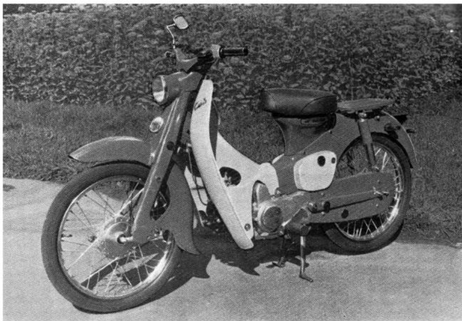
Мотоцикл Хонда С-102 (Япония) снабжен автоматическим сцеплением, пластмассовыми грязезащитными крыльями и брызговиком, электростартером, электрическими указателями поворотов и другим оборудованием, повышающим его эксплуатационные качества.
