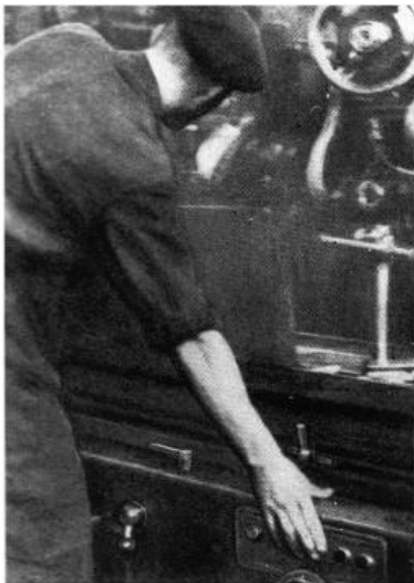
Еще менее удобна рабочая поза шлифовщика при манипулировании кнопками станции управления электродвигателями на станке ХШ-15.
