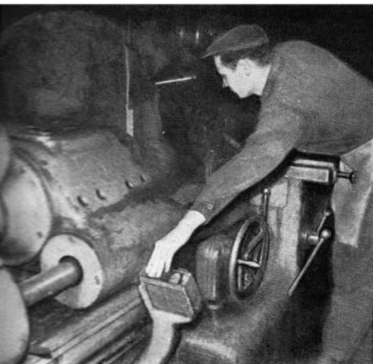
На шлифовальном станке 316М панель с кнопкой пуска изделия расположена в неудобной зоне. Посмотрите, как тянется к ней рабочий.
