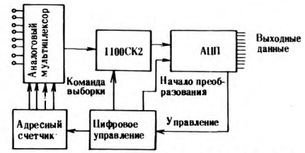
Рис. 5. Функциональная схема системы сбора данных
