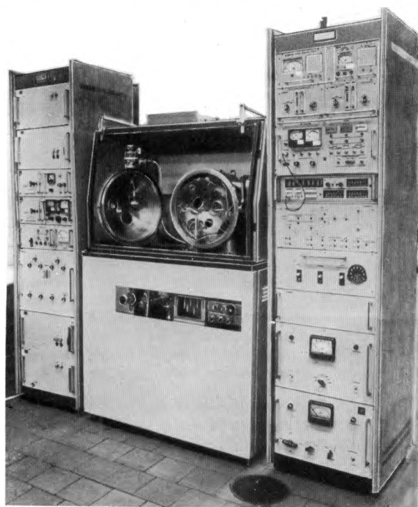
Рис. 1. Внешний вид установки с лазерным испарителем
