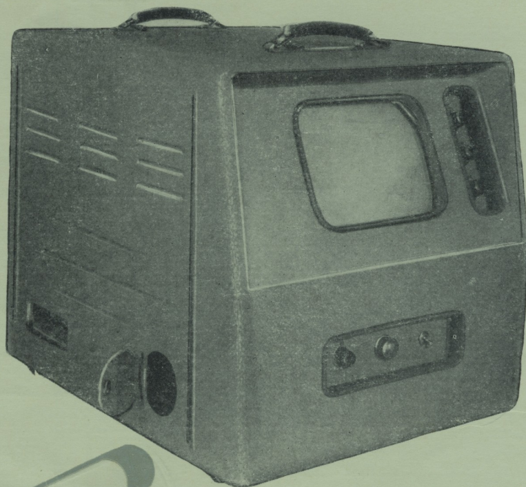
Фиг. 12. Просмотровое (переносное) видеоконтрольное устройство ВК-5
