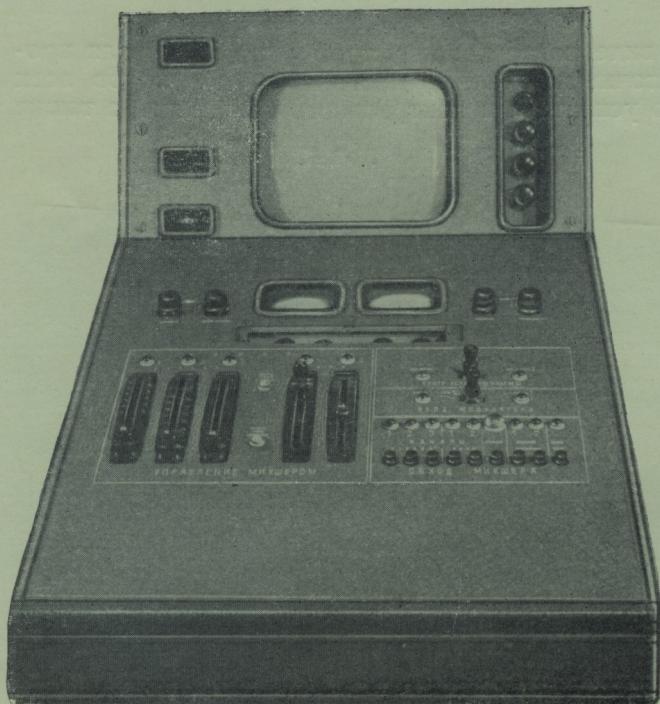
Фиг. 6. Микшерно-линейная секция С-102. Вид на панель управления ПР-9 и на переднюю панель видеоконтрольного устройства ВК-4
