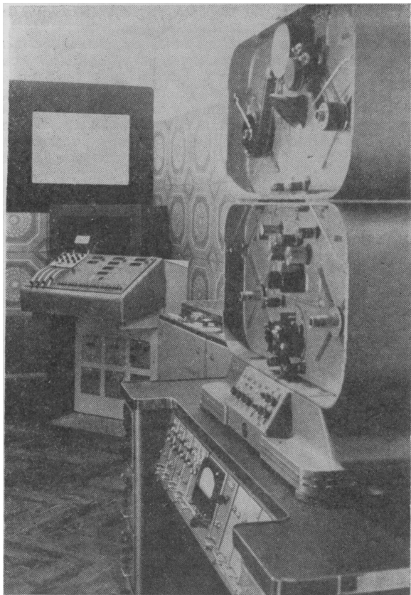
Внешний вид экспериментального комплекса оборудования для электронного монтажа фонограмм синхронно с изображением
