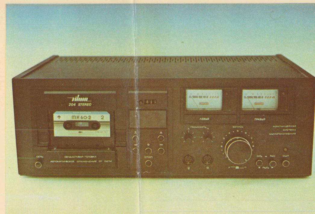
Стационарный стереофонический кассетный магнитофон-приставка «Вильма-204-стерео» предназначен для высококачественной записи и воспроизведения музыкальных программ на три типа магнитной ленты:  $\text{Fe}_2\text{O}_3$ ,  $\text{CrO}_2$ ,  $\text{FeCr}$ .
