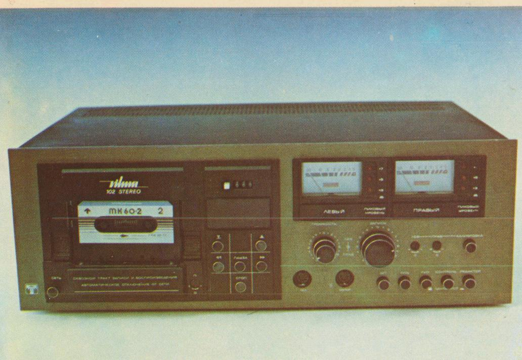
Стационарный стереофонический кассетный магнитофон-приставка «Вильма-102-стерео» предназначен для высококачественной записи и воспроизведения музыкальных программ на магнитную ленту с рабочим слоем  $\text{Fe}_2\text{O}_3$ ,  $\text{FeCr}$ ,  $\text{CrO}_2$ .
