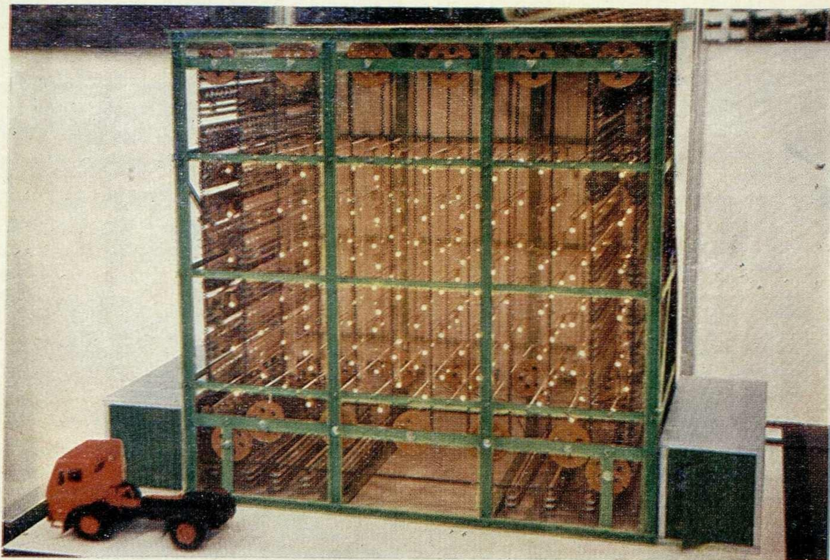
3. Оригинальная конструкция гидропонной башенной теплицы с вертикальными транспортерами, по которым передвигаются лотки с рассадой [Австрия]
