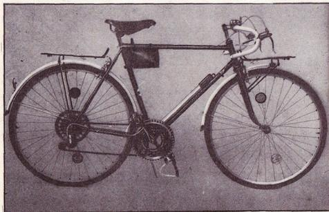
лежностей) — 14 кг. Велосипед «Спорт» мод. 153—412 отличается от базовой модели тем, что его переднее колесо вместо барашка имеет гайку, у втулки заднего колеса пятиступенчатая трещетка и защитный диск. Седло велосипеда «Спорт» с мягкой покрывшей, ручки переключателя передач закреплены на стержне руля. Цена велосипедов: «Турист» — 105 руб., «Спорт» — 120 руб.
