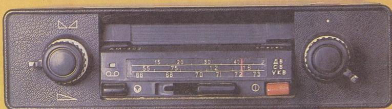
Она принимает радиопередачи в диапазонах ДВ, СВ, УКВ; воспроизводит стерео- и монофонические записи с кассет.
