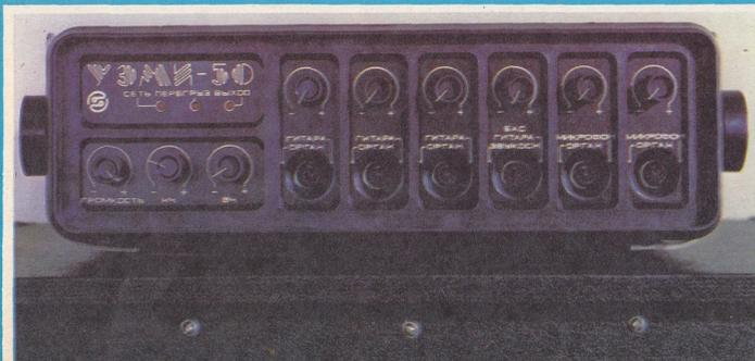
«УЭМИ-50» — усилитель электромузыкальных инструментов с выходной мощностью 50 Вт, имеющий шесть входов для одновременного подключения микрофонов, электрогитар и электроорганы, а также звукоснимателя или радиоприемника. Усилитель выпускается с колонкой «АС-50», содержащей 6 динамических головок типа 10 ГД-36 по 10 Вт каждая, что значительно улучшает (по сравнению с прежней колонкой) акустические данные.
