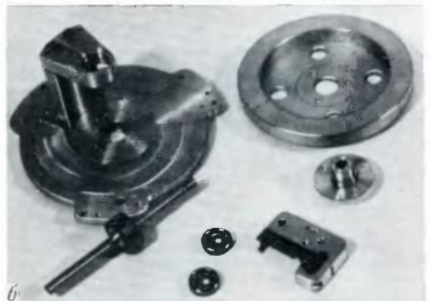
Рис. 2. Ведущий узел пьезопривода в собранном виде (а) и его основные элементы (б)
