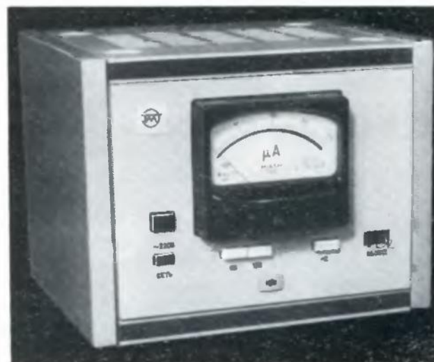
Рис. 5. Блок питания с защитой и индикацией перегрузок по току
