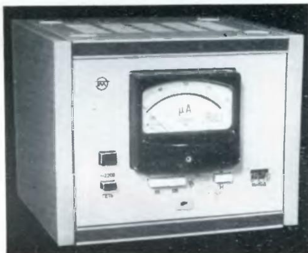
Рис. 4. Блок питания с устройством измерения момента узла подмотки
