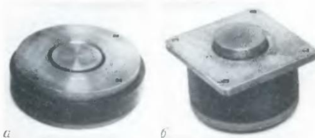
Рис.2. Общий вид магнитных систем на основе магнита из феррита 25БА170 (а) и магнита из сплава ЮН14ДК24 (б) для динамического громкоговорителя 30ГД-1
