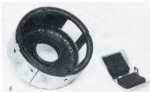
Рис.2. Электродвигатель постоянного тока с наборной магнитной системой на основе сегментных магнитов из феррита бария:
