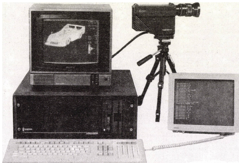
Рис. 1. Аппаратура одноканальной термографической системы Termovision 800
