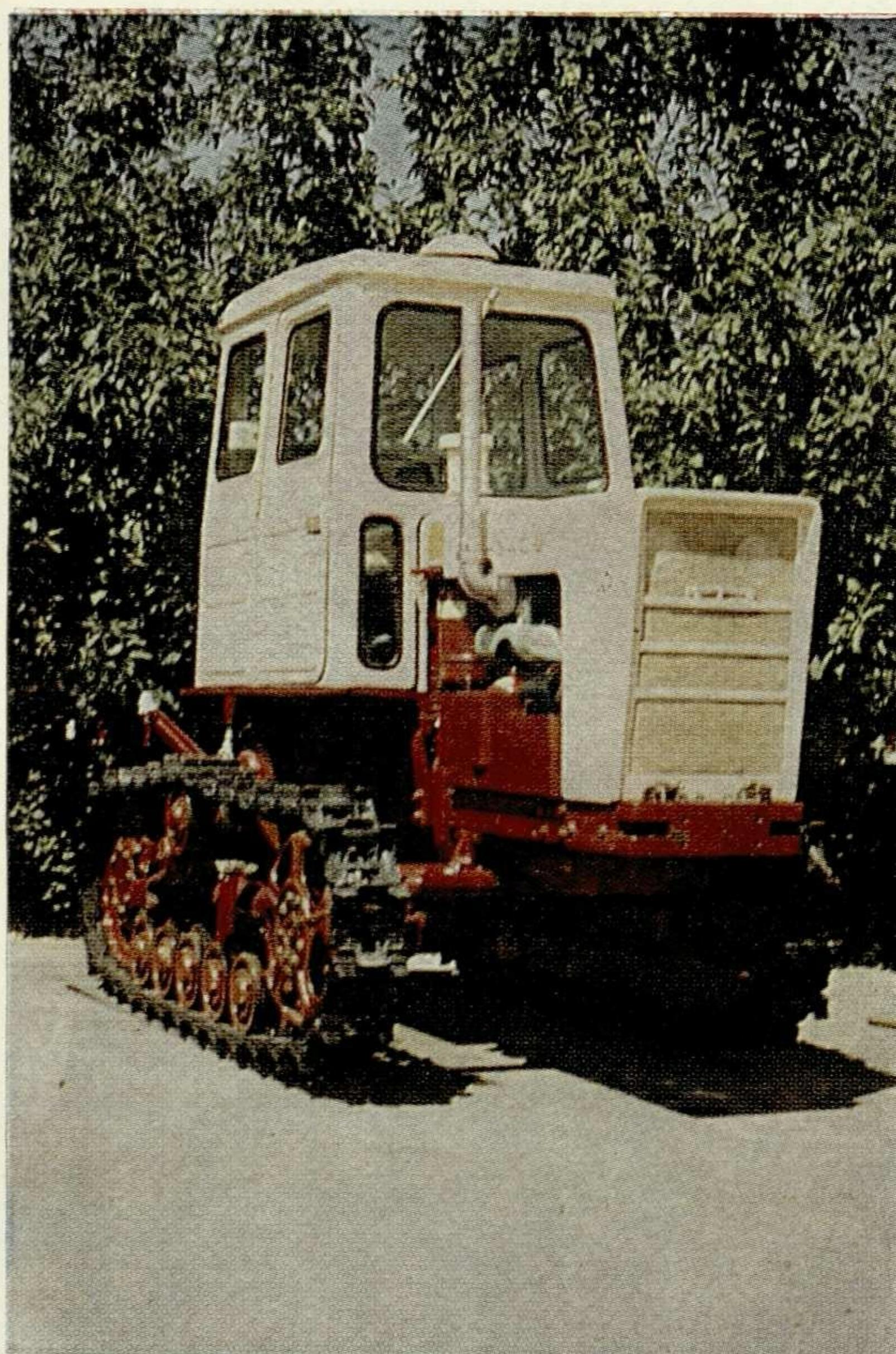
Гусеничный свекловичный трактор Т-54С, выпускаемый Кишиневским тракторным заводом. Может использоваться и как трактор общего назначения. Мощность 55 л. с. 1966 г.
