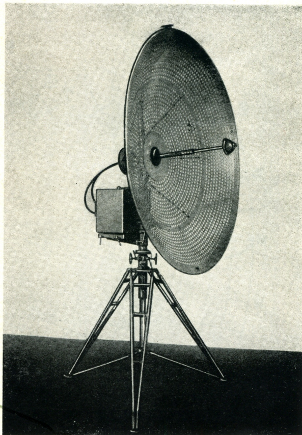
Рис. 9. Передающее антенно-фидерное устройство АТХ-6 с радиопередатчиком
