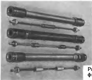
Рис. 8. Внутренние проводники коаксиального трансформатора сопротивлений
