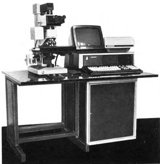
Предназначена для контроля критических размеров элементов топологии на полупроводниковых пластинах и фотошаблонах в условиях производства ИС.
