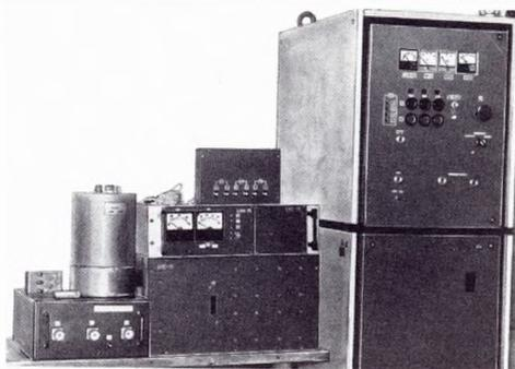
Предназначено для получения различных диэлектрических покрытий при изготовлении изделий микроэлектроники, радиотехники и товаров народного потребления. Используется в составе вакуумных установок.
