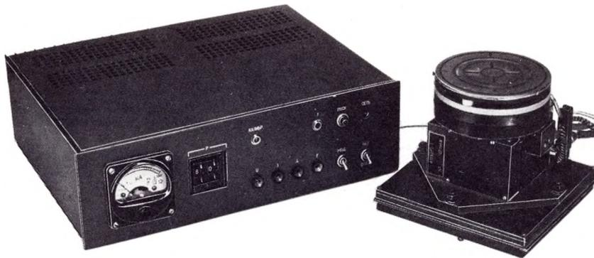
мические элементы в виде плоских колец. Для возбуждения колебаний этих элементов применен ультразвуковой генератор, формирующий сигналы напряжением 1,5—115 В и частотой 38,1—56,7 кГц, которые задаются с помощью программатора.
