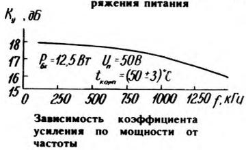
Зависимость коэффициента усиления по мощности от частоты
