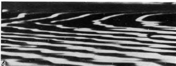
Рис. 6. ОЭМ-изображения поверхности кремния (001), полученные в сверхструктурном рефлексе (1×2) при направлении пучка электронов <110>. Нагрев кристалла осуществлялся переменным током (а) и постоянным током, при этом направление тока противоположно (б) или совпадает (в) с направлением движения ступеней при сублимации
