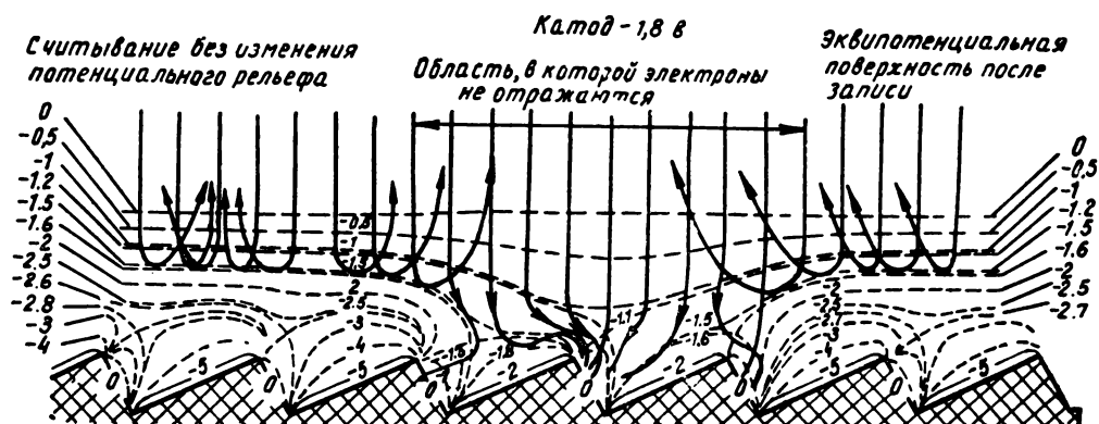
Рис. 6. Картина электрического поля у диэлектрической накопительной ленты трубки с переносом изображения при считывании
