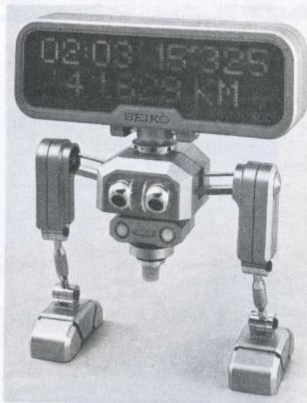
Прибор времени с выводением показани на дисплей «Running Seiko». Прибор може «бежать на собственных ногах» вместе с бегуном на марафонские дистанции. Дизайн К. КУМАНО
