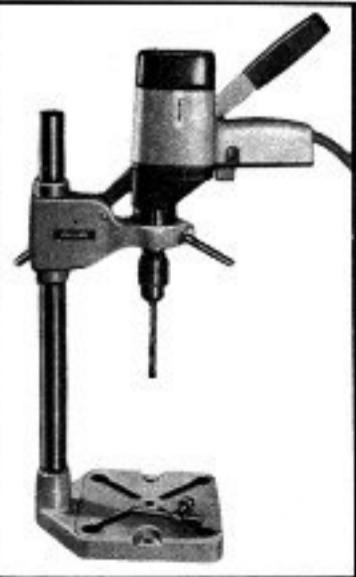
Показанная здесь электродрель (Голландия), имеет пластмассовый корпус. С ее помощью можно обрабатывать металл, дерево, пластмассу и прочие материалы.
