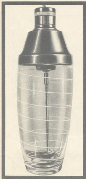
**Миксер [Австрия]** — стеклянный сосуд с металлической хромированной крышкой, в которой размещен электродвигатель, работающий от обычной батарейки к карманному фонарю. К валу электродвигателя присоединен стальной стержень с трехлопастным венчиком. Миксер включается с помощью кнопки, расположенной на крышке сосуда.
