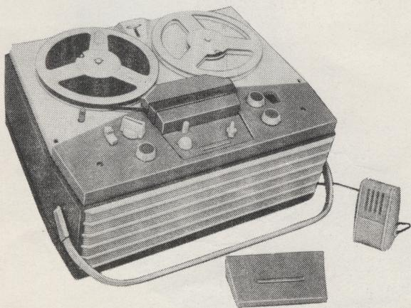
Магнитофон имеет переключатель рода работы, кнопку записи, регулятор громкости, раздельные регуляторы тембра по низшим и высшим частотам, электронно-оптический индикатор уровня записи, переключатель скорости и входов, счетчик метраже ленты. Специальное устройство обеспечивает автоматическое выключение лентопротяжного механизма при обрыве ленты или по окончании ее перемотки.
