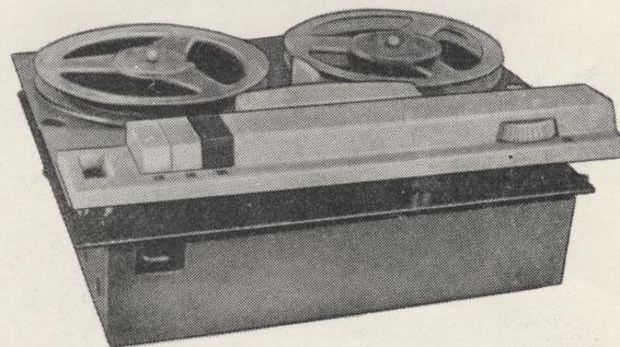
Магнитофонная панель имеет кнопочный переключатель рода работы, регулятор громкости, электронно-оптический индикатор уровня записи.
