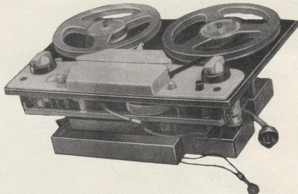
В магнитофонной панели применяются стандартные катушки № 18 для магнитной ленты длиной 350 м. Смена дорожек производится перестановкой и переворачиванием катушек с лентой.
