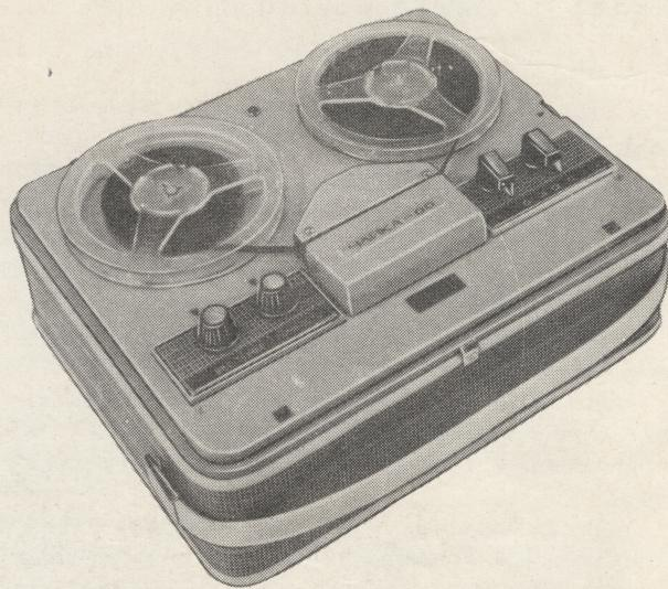
В магнитофоне применяется стандартная катушка № 15 для магнитной ленты длиной 250 м. Смена дорожек производится перестановкой и переворачиванием катушек с лентой.
