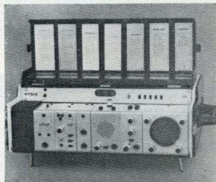
1. Структура диагностической системы: в передней части — блок приборов, в задней — контейнер с принадлежностями
