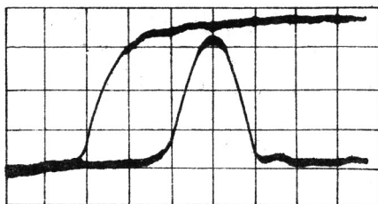
Рис.21. Типовая форма сигнала на выходе камеры на видиконе.
