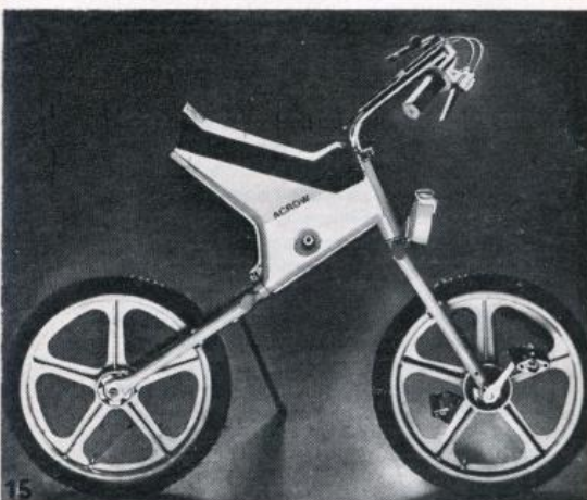
14. Велосипед разборно-складной конструкции, трансформируемый в грузоперевозочный (Голландия)
