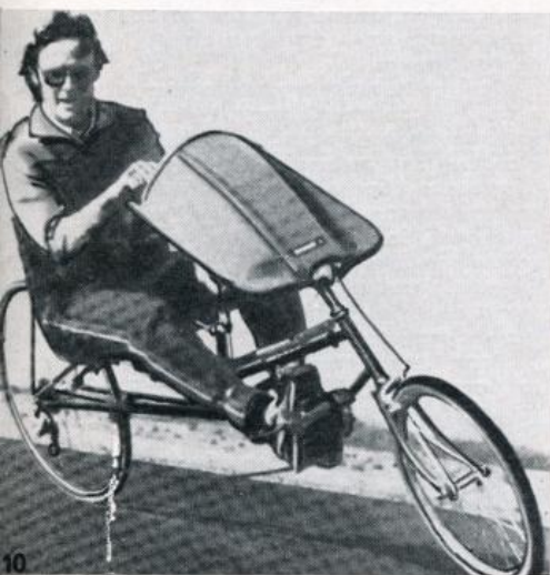
10, 11. Велосипеды оригинальной конструкции, в решении которых предусмотрены средства, снижающие сопротивление встречного потока воздуха. При наличии легкого кузова-обтекателя могут быть преобразованы в веломобили
