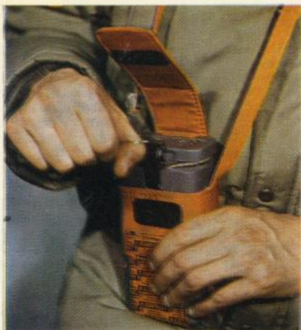
4. Включение радиомаяка в походном положении
