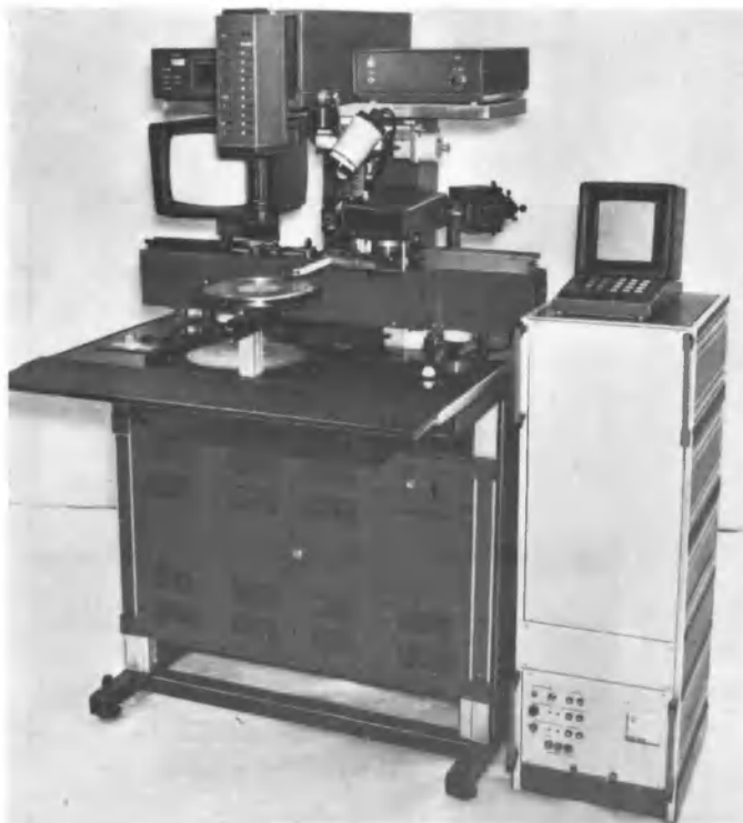
Установка присоединения ленточных выводов к кристаллам ЭМ-4062
