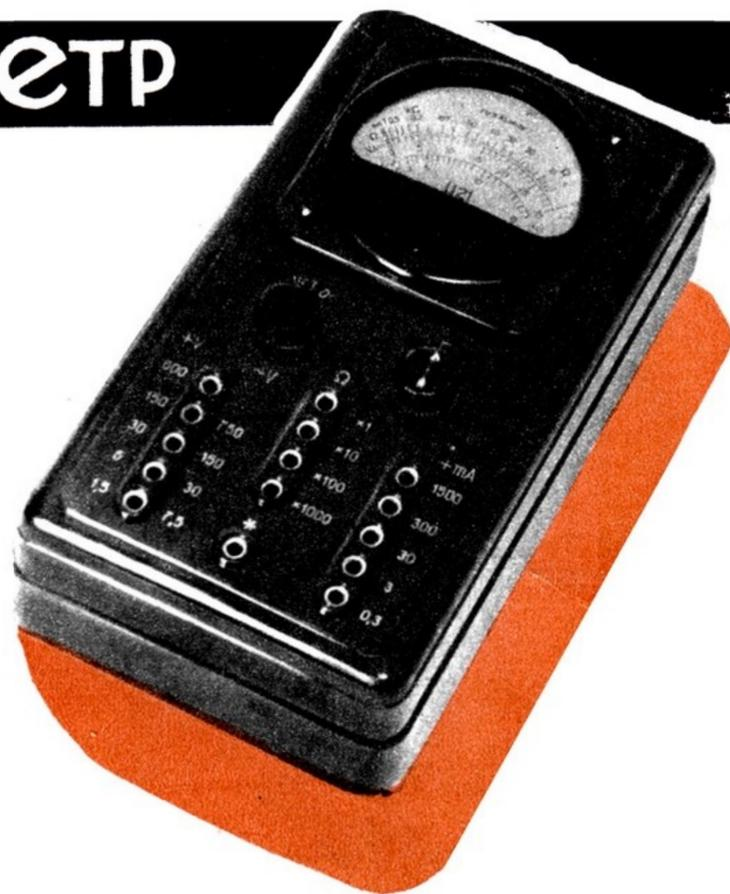
Источники питания омметра расположены внутри прибора в специальной камере, доступ к которой осуществляется с его нижней стороны.
