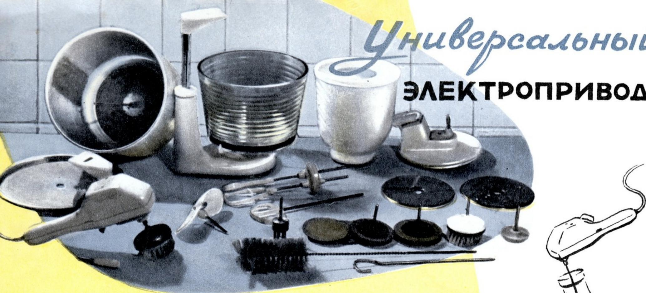
Датский универсальный двухскоростной электропривод продается с комплектом различных насадок, с помощью которых можно производить обработку продуктов и выполнять другие домашние работы. Основной частью его является миниатюрный коллекторный электродвигатель, встроенный в пластмассовый корпус с удобной ручкой. Мощность двигателя 35 вт, число оборотов 1 300 и 1 800 в минуту, он рассчитан на напряжение 220 в.
