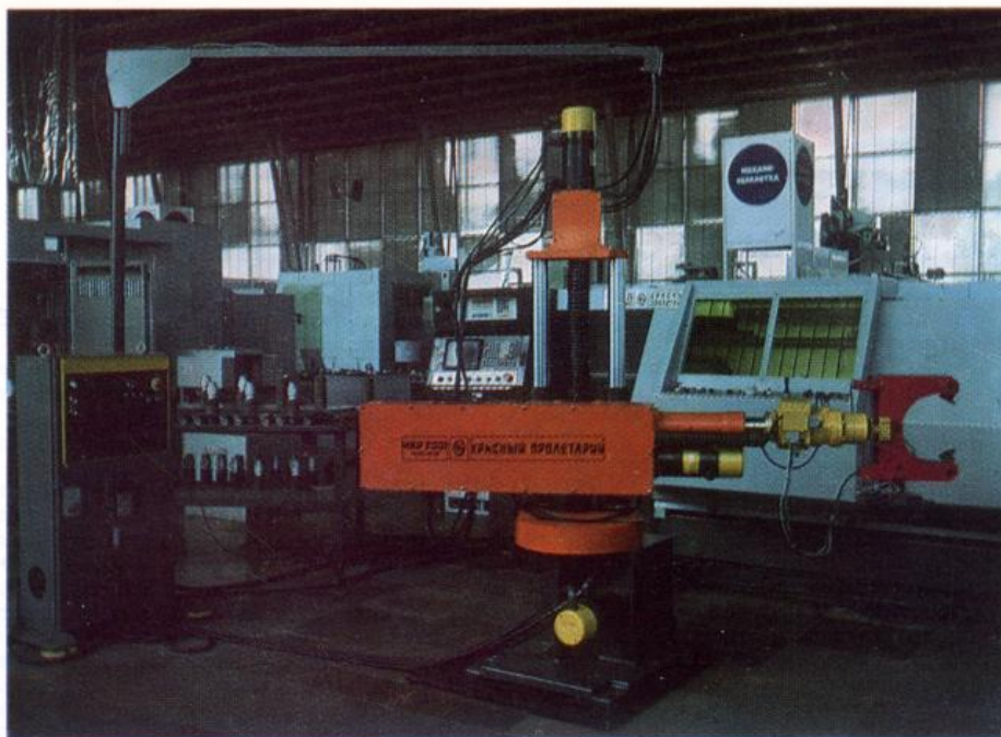
1, 2. Гибкий производственный модуль 1720ПФ30 и промышленный робот М10П6201, в разработке которых принимали участие дизайнеры завода, — экспонаты ВДНХ СССР
