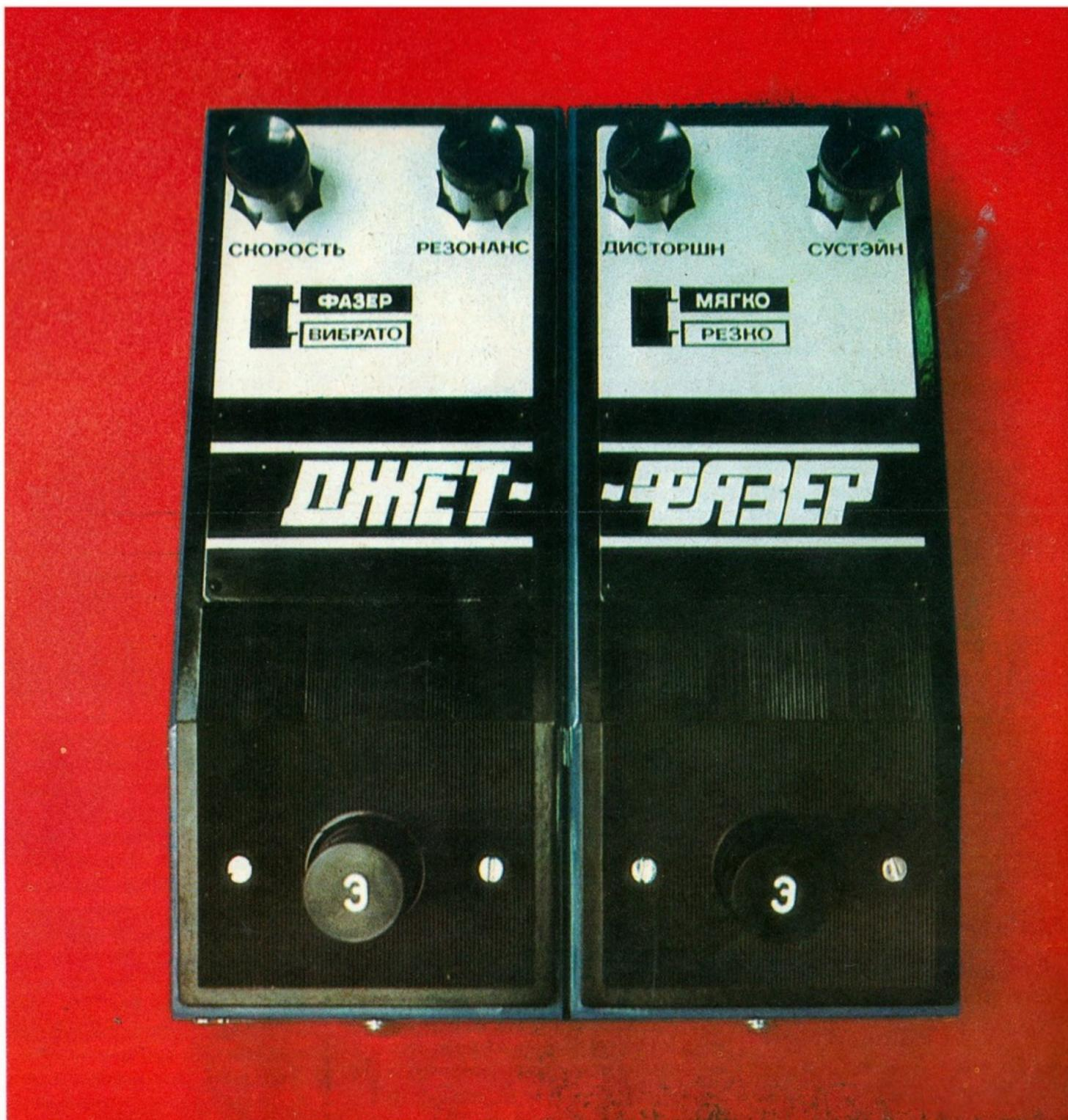
них придает звучанию любого электромузыкального инструмента пространственную объемность. Звук, благодаря этому прибору, как бы переливается. Питание осуществляется от батарей "Крона" или внешнего источника питания. Напряжение выходного сигнала не менее 30 мВ. Напряжение питания 9 В. Ток потребления не более 20 мА. Цена — 110 руб.
