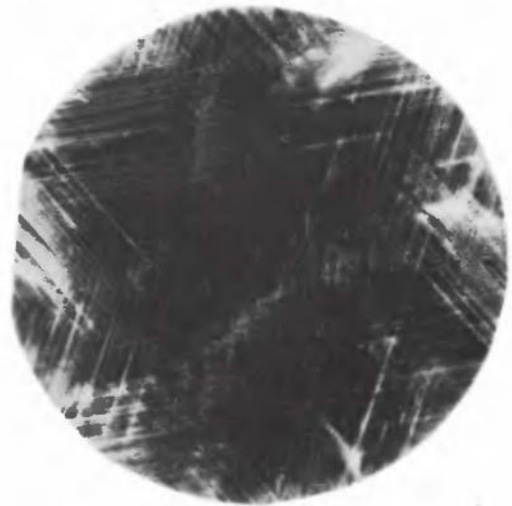
Рис. 3. Полосы скольжения на пластине после жесткого режима термообработки
