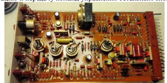
Рис. 21. Блок управления магнитами (БУМ), управляет электромагнитами подвода ленты, левого датчика натяжения ленты, электромагнитами тормозов.
