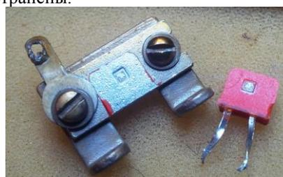
Рис. 38. Транзистор КТ807Б с отвалившимся кристаллом.
