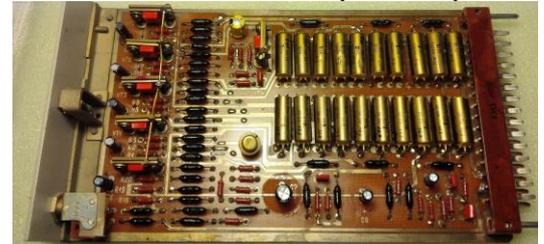
Рис. 20. Блок управления режимами (БУР). Осуществляет коммутацию и передачу команд управления остальным блокам.
