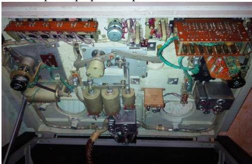
**Рис. 24.** Плита ЛПП, открытая для обслуживания. Двигатели сняты.
