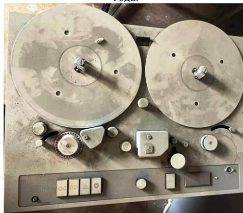
Рис. 5. Магнитофон для перезаписи на лаковый диск МЭЗ-204СМ на базе модификации МЭЗ-102БМ не ранее 1984 года
