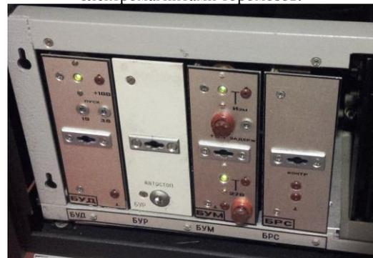
Рис. 22. Расположение блоков на примере МЭЗ-102БМ 1986 г.в.
