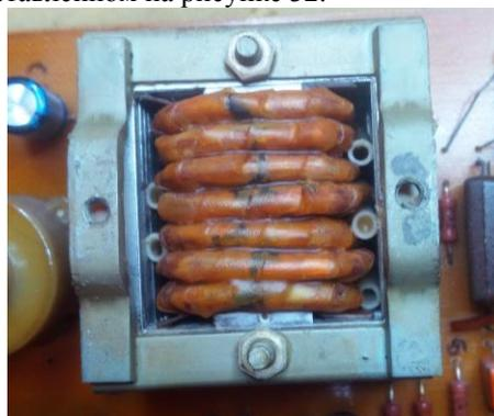
Рис. 34. Входной симметрирующий трансформатор блока записи без экрана.
