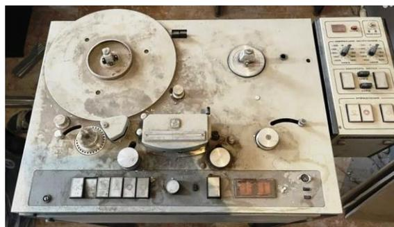
Рис. 4. Магнитофон для записи подготовительной ленты для перезаписи на лаковый диск, с блоком записи команд МЭЗ-112С, на базе модификации МЭЗ-102БМ выпуска не ранее 1984 года.
