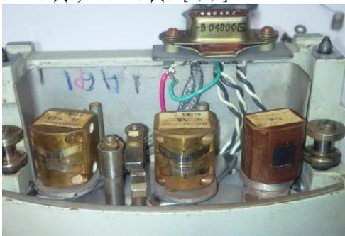
Рис. 36. Блок головок стереофонического магнитофона МЭЗ-102Б
