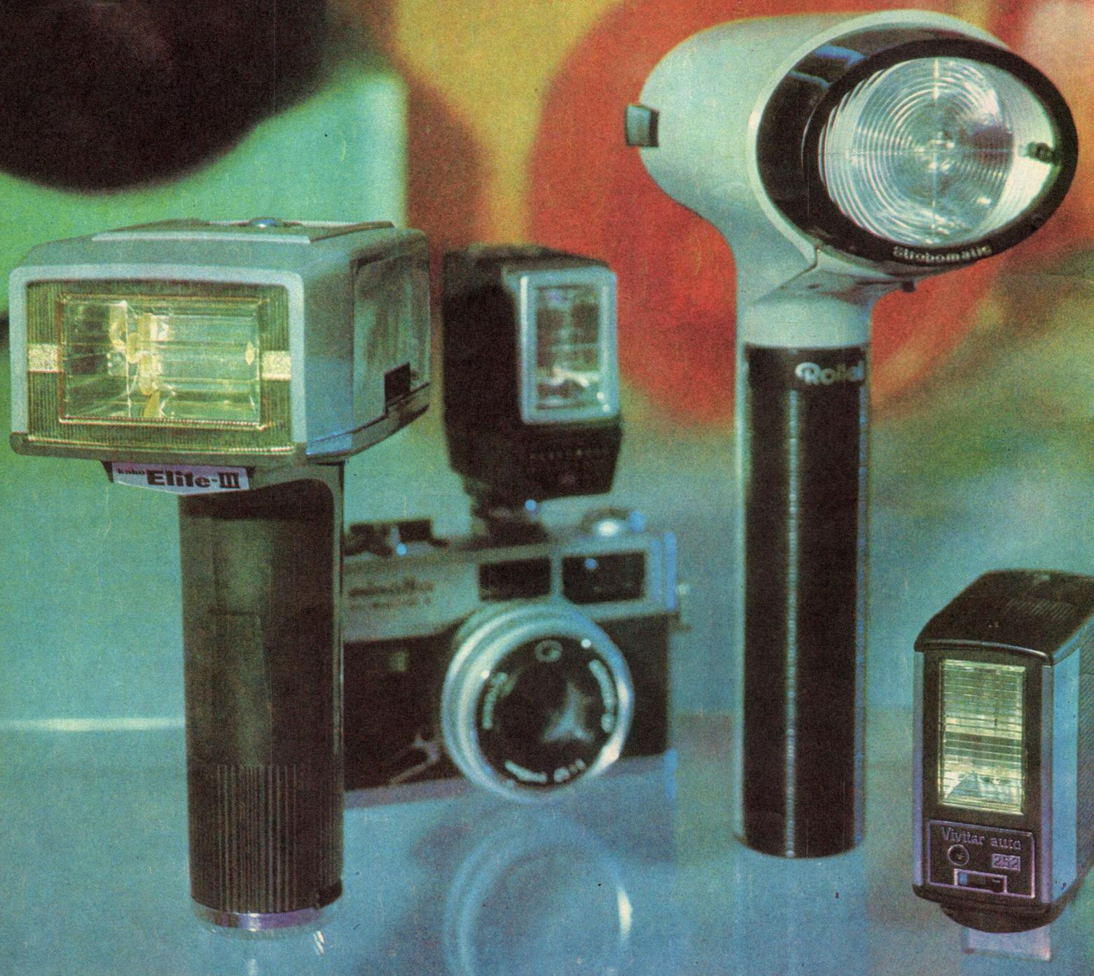
За рубежом большим спросом пользуются портативные электронно-импульсные фотовспышки различных моделей. Они очень удобны в эксплуатации, имеют небольшие габариты и вес, питание получают от щелочных или никелекадмийевых аккумуляторных батарей, расположенных в корпусе. Наряду с простыми фотовспышками выпускаются и автоматические, в которых в качестве светоприемника используется сернистокадмийный фоторезистор.
