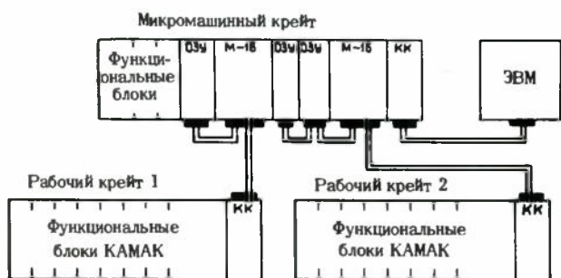
Рис. 10. Пример организации трехкрейтной системы КАМАК с использованием МПК М-16
