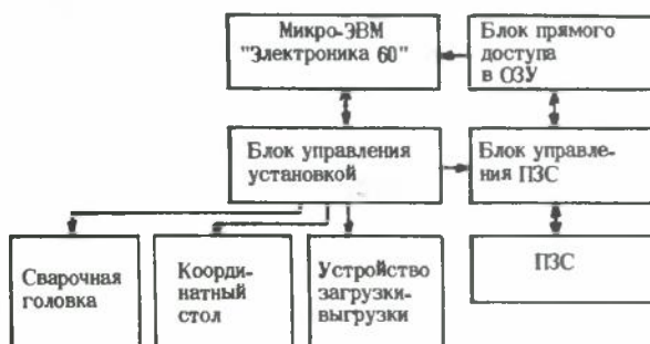
Рис. 5. Структурная схема автомата микросварки ОЗУН-7100М3
