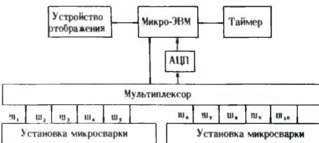
Рис. 6. Система контроля качества микросварки: \psi_1, \psi_6, \dots — шины запроса диагностической информации; \psi_2, \psi_7, \dots — шины запроса запуска сварки; \psi_3, \psi_8, \dots — шины контроля; \psi_4, \psi_9, \dots — шины запуска сварки; \psi_5, \psi_{10}, \dots — шины сигнализации
