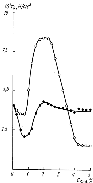
Рис. 2. Зависимость предельного напряжения сдвига от массового содержания ПАВ по отношению к массе \gamma\text{-Fe}_2\text{O}_3 для наполненных суспензий: Обозначение ПАВ такое же, как и на рис. 1
