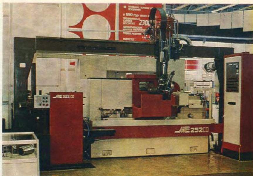
3. Гибкий производственный модуль на базе шлифовального станка ME-252 (1987 г.)
