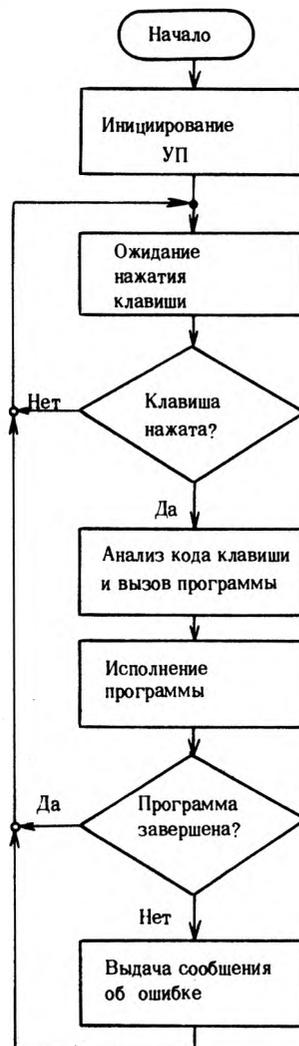
Рис. 6. Алгоритм функционирования управляющей программы
