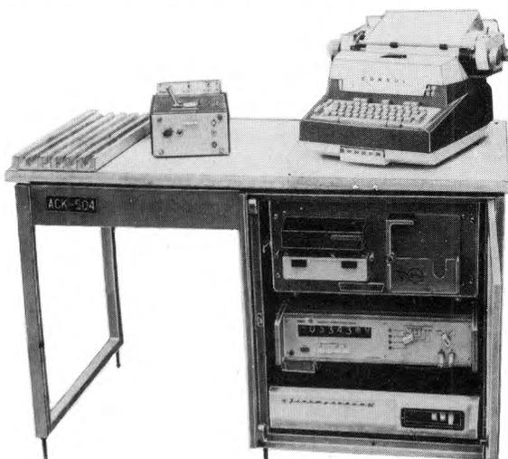
Автоматизированная система контроля АСК-504 на основе микроЭВМ «Электроника 60М» предназначена для подбора бескорпусных микросхем К129НТ1 в группы по две и четыре по номиналам. В состав системы входит измерительный пульт, с помощью которого микросхемы по командам ЭВМ подключаются к измерительным цепям и индицируется окончание измерения или отсутствие контакта выводов микросхемы с контактной головкой, ЭПМ «Консул-260», устройство параллельного обмена и цифровой вольтметр Ц68003.
