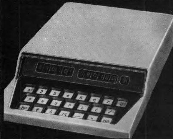
Предназначен для отладки математического обеспечения систем управления, построенных на базе микроЭВМ «Электроника 60». Позволяет заменить в процессе наладки системы ЭПМ «Консул-260».
