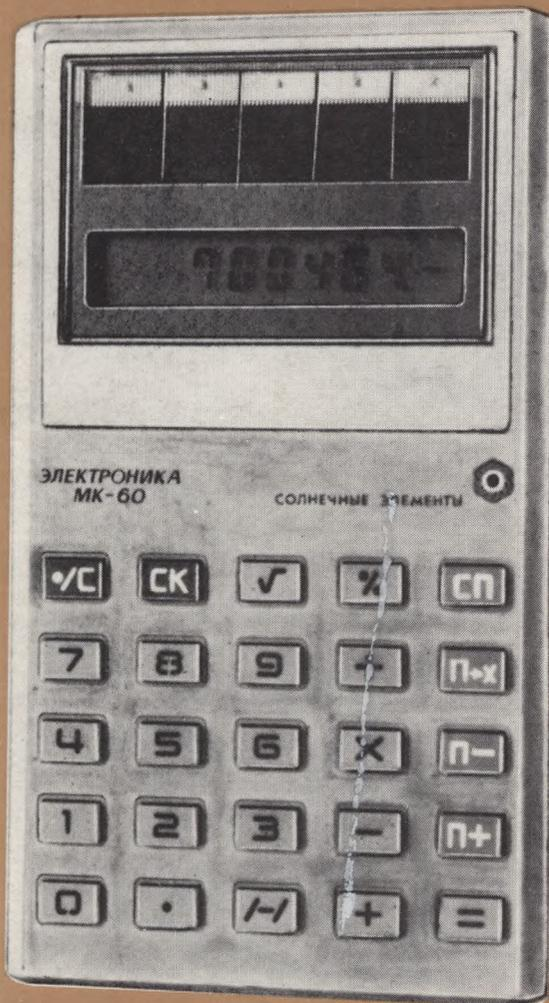
Снабжен устройством автоматического отключения питания, которое срабатывает через 10—12 минут после выполнения последней операции. Источником искусственного освещения служит лампа накаливания мощностью 100 Вт, расположенная на расстоянии не более 2 м, или флюоресцентная лампа мощностью 15 Вт — на расстоянии не более 60 см.
