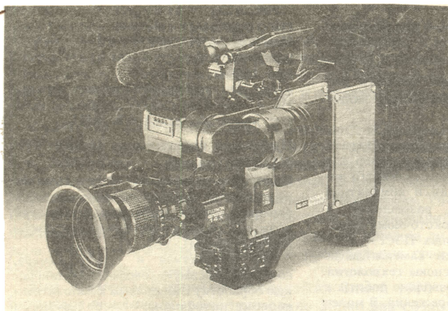
Рис. 4. Вещательная телекамера на трех матрицах ПЗС с цифровой обработкой сигнала HL-57
