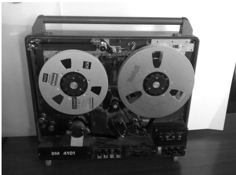
Рис. 5. Репортажный видеомэгнитофон ВМ-4101 со снятой верхней панелью
