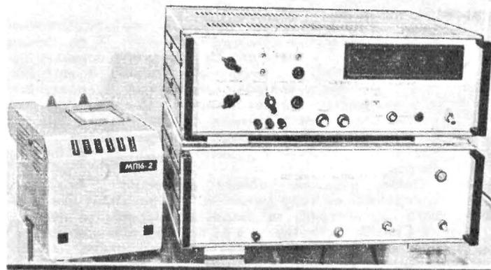
Цифровой вольтамперметр ВК2-20 с согласующим устройством СУ-1 и цифropечатающим аппаратом МП16-2.
