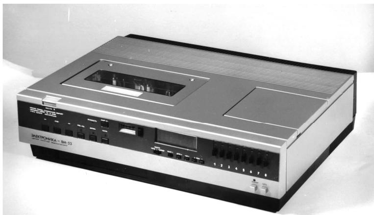
Рис. 12. Общий вид видеомэгнофона «Электроника ВМ-12»
