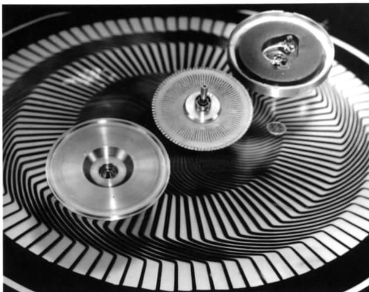
Рис. 6. Двигатель постоянного тока с интегральной обмоткой якоря
