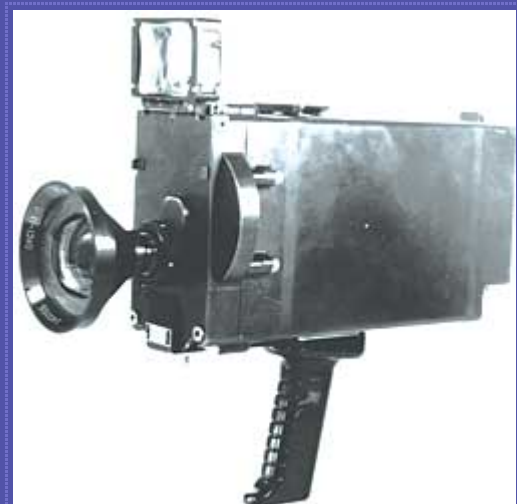
Камера АР — первая цветная космическая репортажная телекамера, использовавшаяся впервые в ходе совместного полета «Аполлон-Союз» в 1975 году (главный конструктор В. Б. Иванов). Разработка ВНИИТа на трубках ЦНИИ «Электрон»
