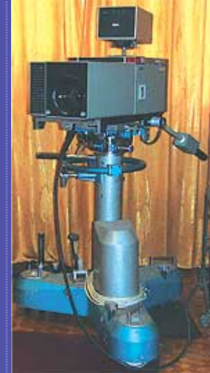
Камера КТ-132. Такими студийными камерами оснащались все телецентры СССР (более 100 телецентров). Разработка ВНИИТа на трубах ЦНИИ «Электрон»
