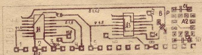
ГЕНЕРАТОР СИНХРОИМПУЛЬСОВ 5-А6
