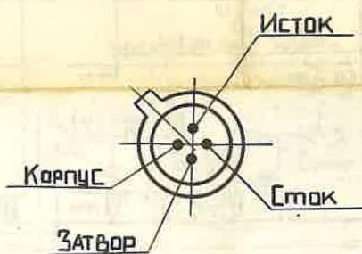
СХЕМА СОЕДИНЕНИЯ ЭЛЕКТРОДОВ
