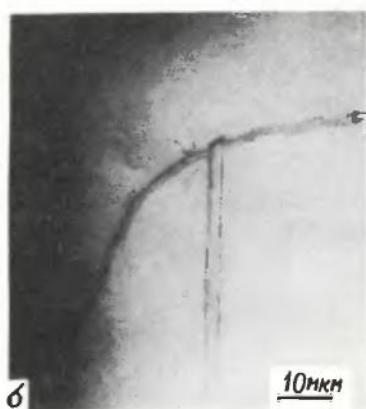
Рис.3. Непланарные гетероструктуры на основе МТР: а — схема расположения широкозонных (InP) и узкозонных ( Ga_{x-1-x}P_{1-y}As_y ) слоев; б — микрофотография поперечного сечения структуры после легкого селективного травления
