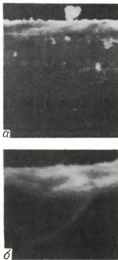
Рис. 1. Вертикальные изломы шлифованной стеклянной пластины: а — нарушенный слой при использовании порошка карбида кремния; б — нарушенный слой при использовании гранатовых порошков
