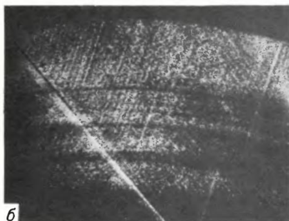
Рис. 5. Полосчатое распределение дислокаций в кристалле кремния, возникающее в процессе роста (а) и в результате термоудара (б)
