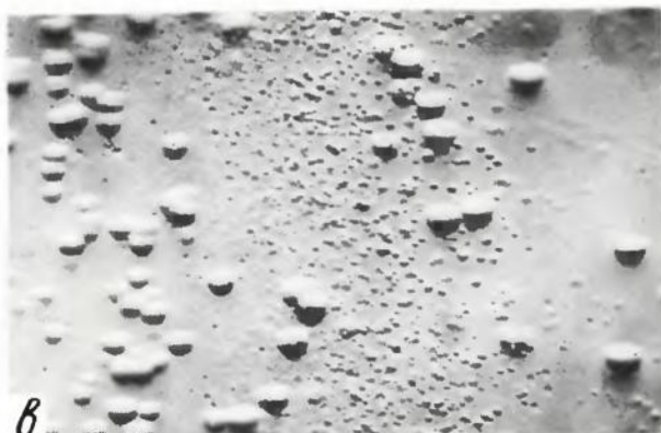
Рис. 1. Макрокартина (а) и микроструктура (б, в) "свирл-дефектов" в пластинах кремния
