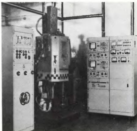
Установка для получения монокристаллов GaP диаметром до 65 \pm 2 мм
