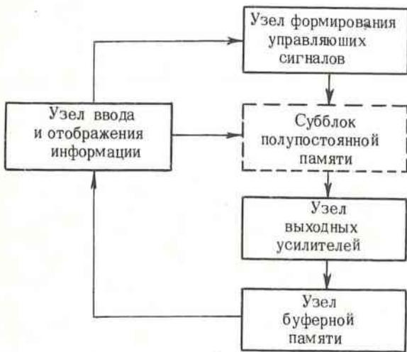
Рис. 2. Структурная схема модуля полупостоянного запоминающего устройства
