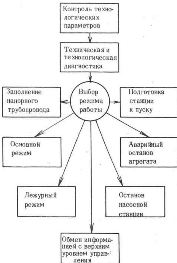
Рис. 1. Функциональная схема локального регулятора
