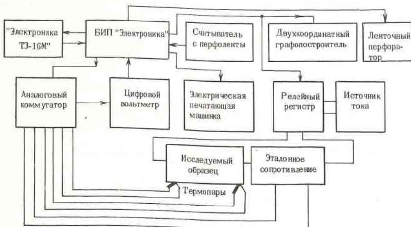
Схема автоматизированной установки для измерения электрических и термоэлектрических свойств металлов и полупроводников
