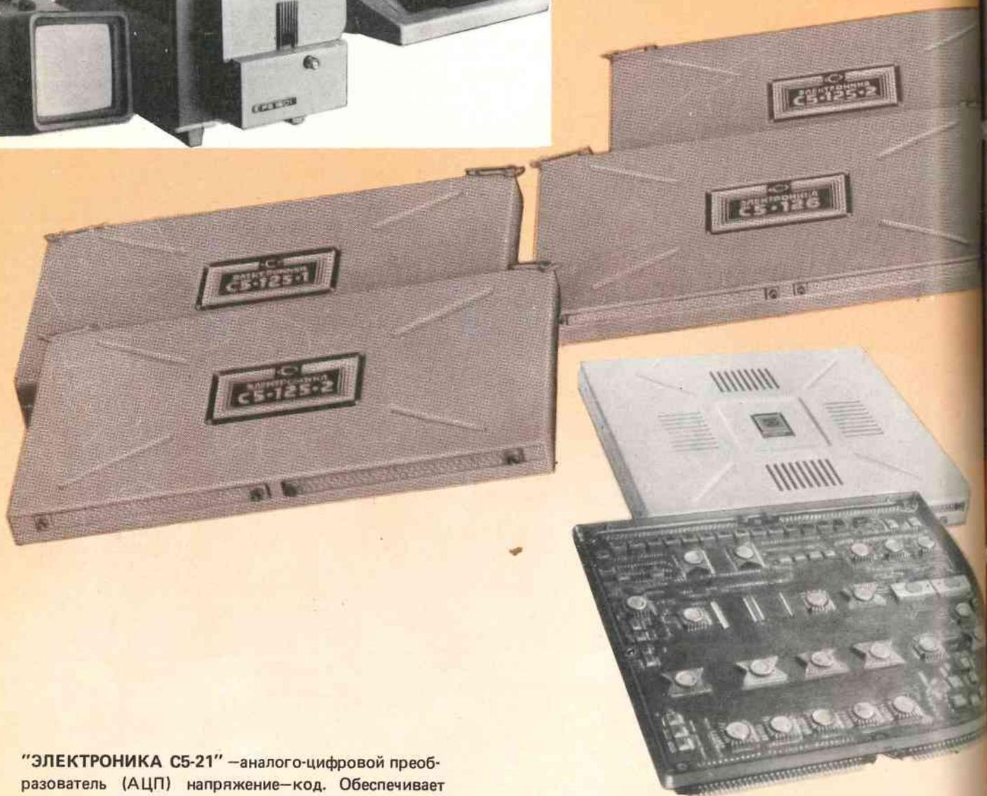
«ЭЛЕКТРОНИКА С5-21» — аналого-цифровой преобразователь (АЦП) напряжение—код. Обеспечивает преобразование напряжения постоянного тока в диапазоне от -10 до +10 В:
