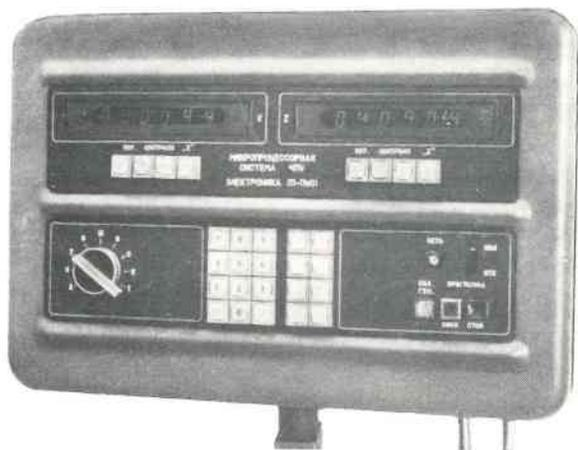
Рис. 1. Устройство ЧПУ токарным станком
