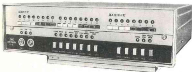
Рис. 2. Микро-ЭВМ "Электроника К1-10"
