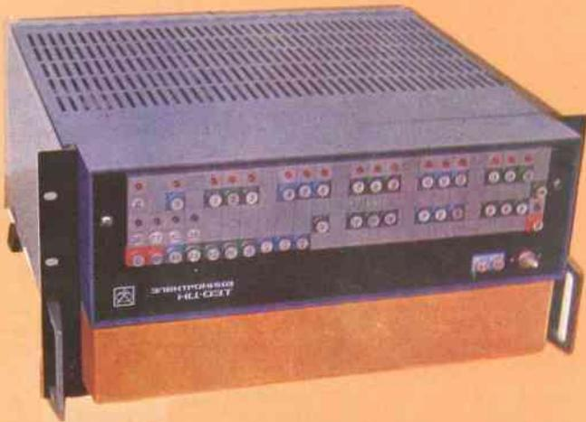
Применяется в системах управления технологическими процессами, измерительным и контрольно-испытательным оборудованием, для сбора и предварительной обработки данных в информационно-поисковых комплексах, для решения инженерных вычислительных задач, а также в качестве периферийных программируемых контроллеров терминалов в вычислительных комплексах.
