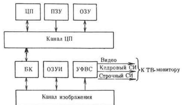
Рис.2. Структурная схема ВТУ с разделением каналов
