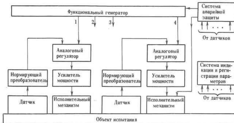
Рис. 1. Структурная схема САУ испытательного стенда
