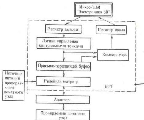
Рис. 1. Структурная схема системы диагностирования печатных узлов
