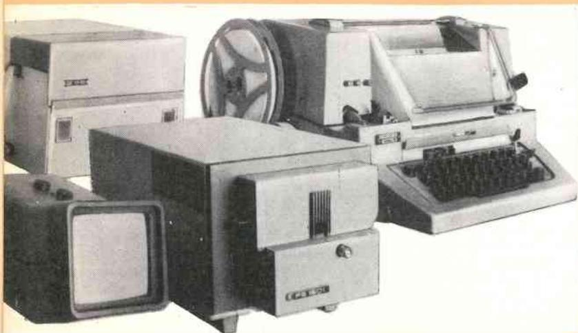
Модули предназначены для построения систем локального контроля и управления на основе микро-ЭВМ. Расширяют возможности применения микро-ЭВМ «Электроника С5-12», обеспечивают гибкость и универсальность при проектировании систем. Имеют единое конструктивное исполнение и одинаковые габариты 298x165x29 мм.
