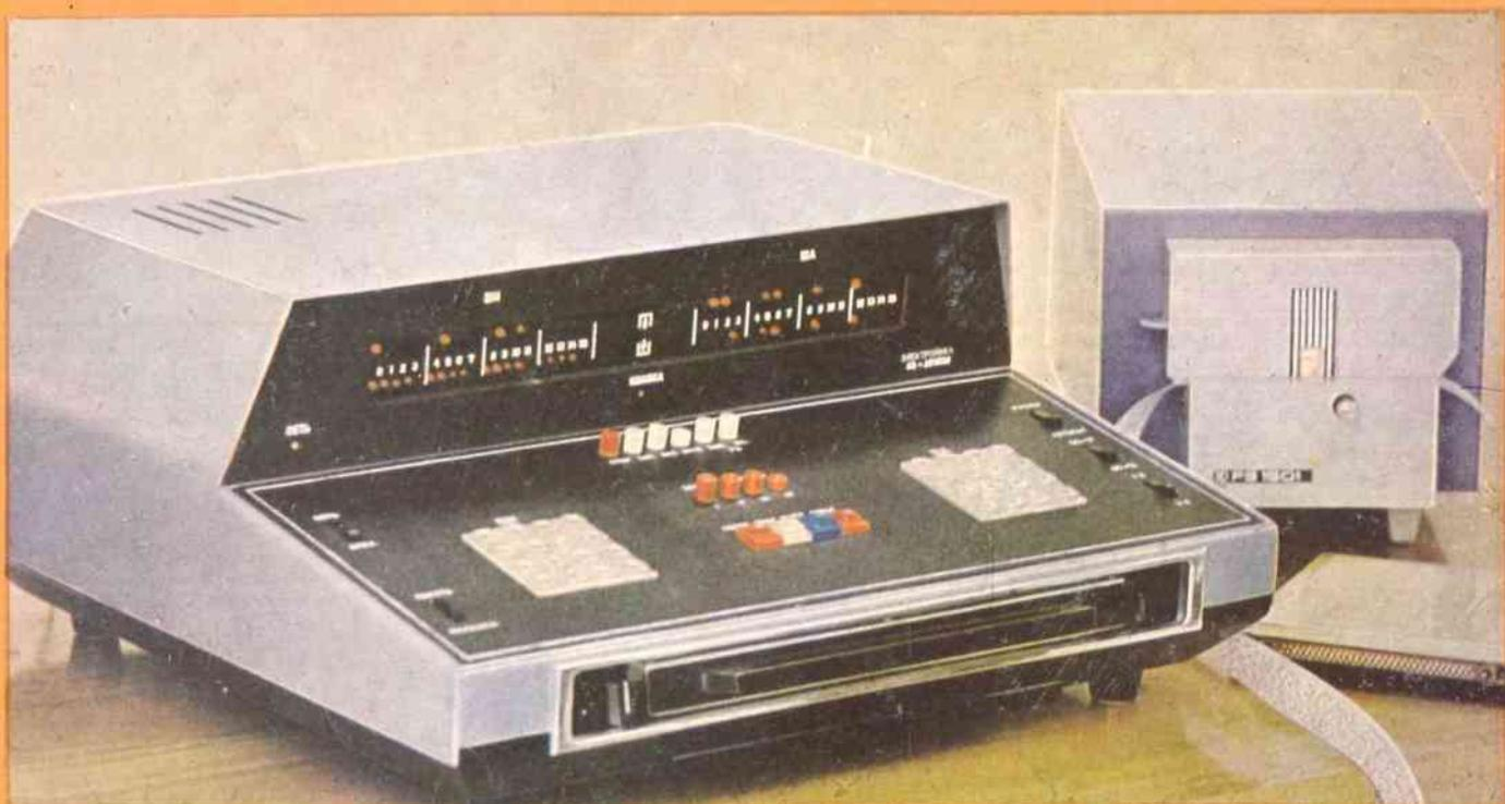
● Предназначено для стирания, записи, считывания и контроля информации в блоке "Электроника П5-ППЗУ".
