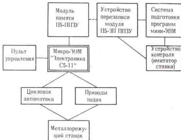
Рис. 2. Структурная схема устройства "Электроника П1-ПУ01"
