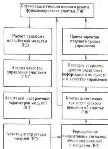
Рис. 3. Функциональная структура модуля "Координатор"
