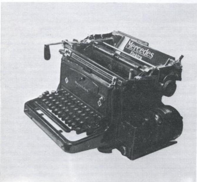
8. «Мерседес — Электра» (Германия), первая электромеханическая машинка, получившая практическое применение. Серийный выпуск этой модели, созданной на базе механической машинки «Мерседес», был начат в 1921 году
