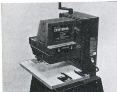
**Небольшой фугочный станок для самоделщиков** выпустила фирма Sears, США. Максимальная ширина материала 300 мм, максимальная толщина 110 мм. Электродвигатель на 1,5 кВт. Станок доставляется с опорной рамой, направляющими и 18-ю видами резцов, которые имеют режущие кромки с двух сторон. При затуплении одной стороны резец можно перевернуть и пользоваться другой стороной. Popular Mechanics.—1990.—Vol.167.—№ 2.—P.85: 7 ill.
