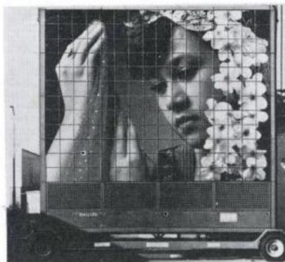
**Журнал представляет телевизоры с большими экранами:** до 8,26×6,19 м — нидерландская фирма PHILIPS, японские фирмы Sony — до 40×25 м и Matsushita — 6 м. Система Philips применяет 350 000 жидких кристаллов (3-х цветов), которые подсвечиваются специальными светодиодами. Преимущество системы — сплошное изображение без заметных промежутков. Недостаток — высокая цена, в 3 раза дороже экранов, составляемых из обычных ЭЛТ. Science et Vie.—1990.—№ 870.—P.126-127: 2 ill.
