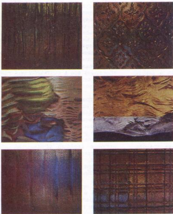
3. Оптические трансформации, создаваемые современными материалами: матовое узорчатое стекло, цветное и бесцветное, применяемое для остекления дверных и оконных проемов, перегородок (экспозиция СССР на выставке «Стройиндустрия-87»)
