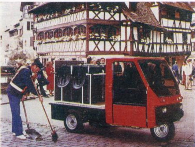
6. Трехколесный электромобиль «Электра», предназначенный для использования в городском хозяйстве. Вариант применения — мусоровоз. Изготовитель Electricité de Strassbourg, Франция. 1983 год
