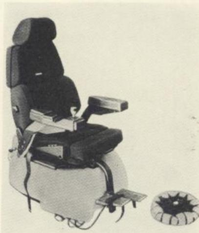
Трехколесное усовершенствованное инвалидное кресло, которое может передвигаться во всех направлениях, выпускается фирмой Intex Medical Technologies (США). Довольно большие колеса при этом не меняют своего направления, а вдоль их обода имеются 20 бочкообразных резиновых роликов, которые могут вращаться перпендикулярно к плоскости колес и тем самым произво-
