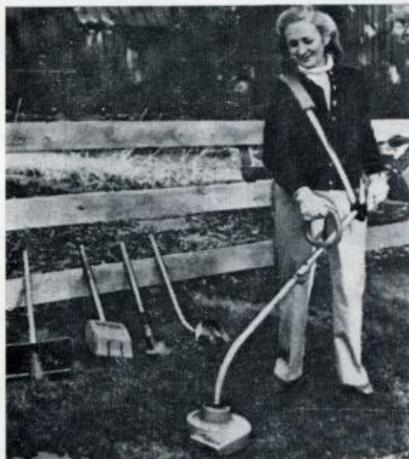
Универсальный источник мощности в виде бензодвигателя (1 л. с.) и пять насадок к нему для садово-огородных работ выпустила фирма HMC (США). Насадки легко и быстро сменяются и состоят из плетевой косилки, культиватора, краеподравнивателя, воздуходувки для собирания в кучу листьев и скошенной травы и снегомета, очищающего полосу шириной 0,3 м при глубине снега 0,175 м.
