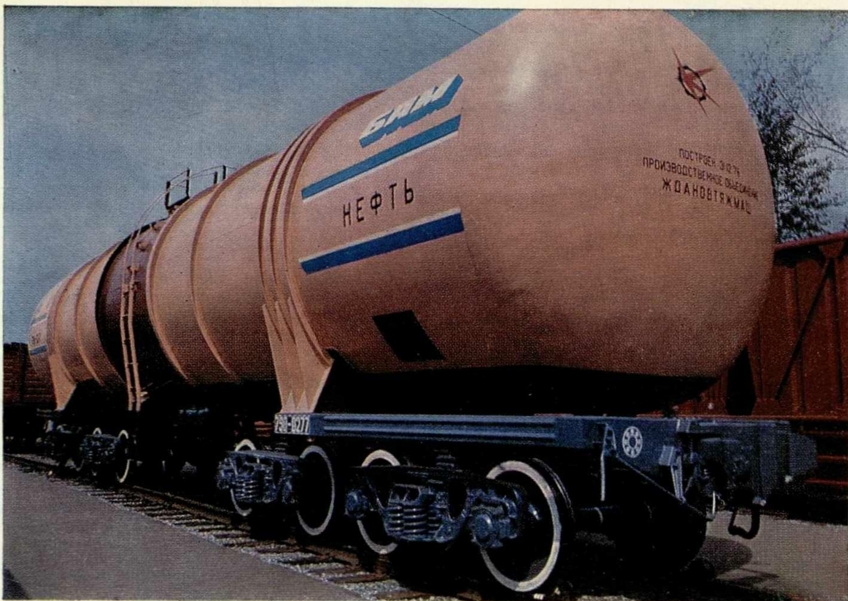
7. Восьмиосная цистерна грузоподъемностью 125 тс
