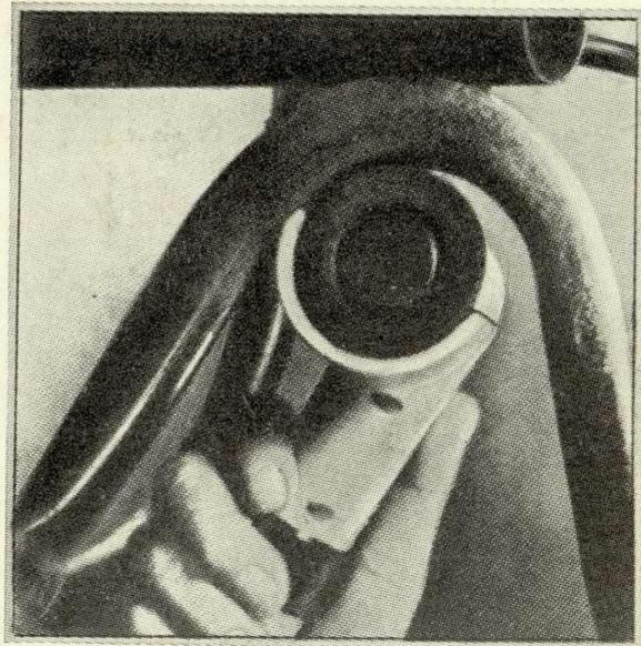
**Освещаемая изнутри ключевина дверцы** применена в автомобилях "Chrysler" (США). Освещение осуществляется через стекловолоконный кабель и круговую линзу, окружающую ключевину. Источником света является электролампочка, помещаемая внутри дверцы и зажигающаяся при нажиме на ручку дверцы. Эта же ручка зажигает ряд лампочек внутри кузова, которые по истечении 30 с автоматически выключаются.
