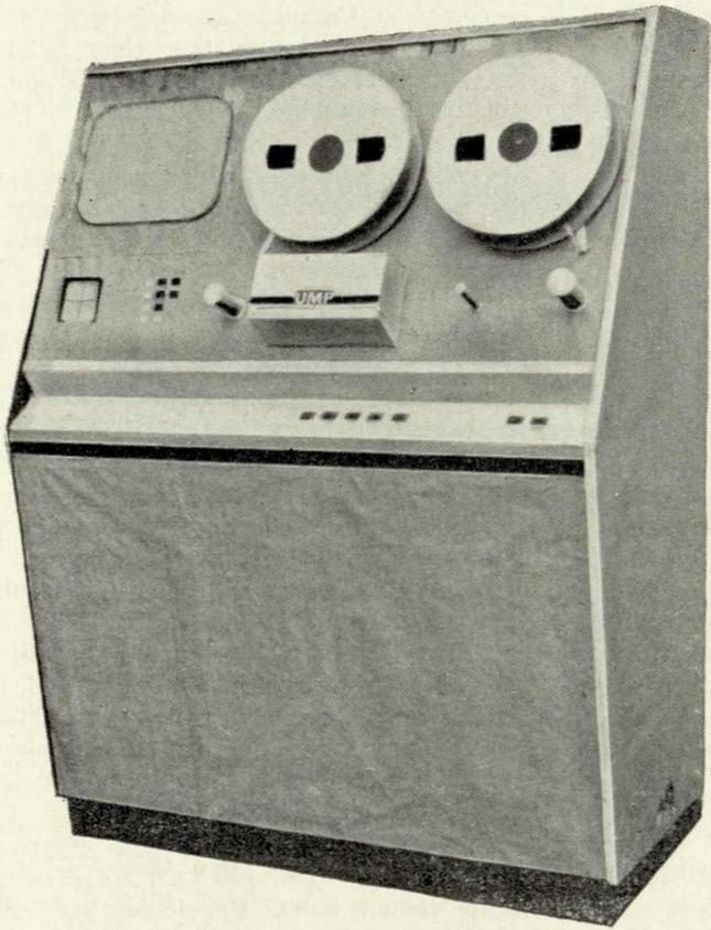
1. Макет видеоманитофона; его каркас собран из деревянных реек и оклеен плотной бумагой. Элементы управления и приборы изображены графически. Такой макет можно сделать за 2—3 часа. Он дает возможность почувствовать реальный объем, масштаб, проинмитировать работу оператора. Может быть использован как промежуточная стадия художественно конструкторской разработки.
